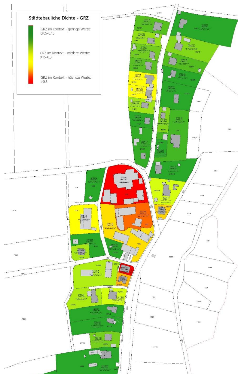
Abbildung 6: Analyse/ überschlägige städtebauliche Dichte im Bestand, Grundflächenzahl, Darstellung raumstation
